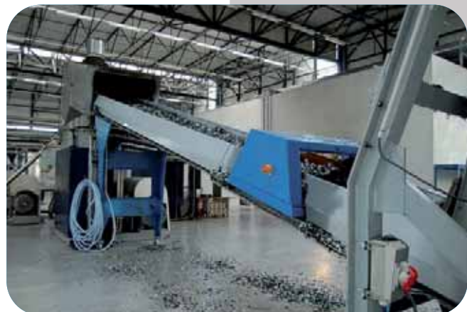
Le tapis roulant où le polyéthylène est acheminé vers l'extrudeuse.
